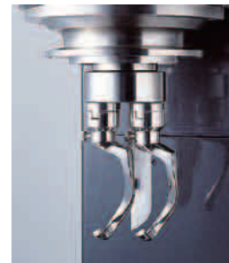
ステンレススパイラルフック (オプションスクレーパー使用)
