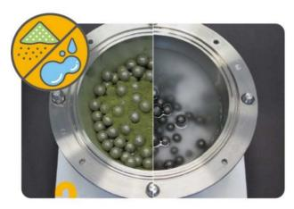
気密性の高い球体容器を採用することにより、有機物・無機物に対応し、さらに乾式・湿式双方での処理が可能です。乾式では、容器内発熱の抑制により、食品・薬品などの熱影響を抑えたい材料の処理に適しています。湿式では、剥離粉砕の特長を利用した、黒鉛などの積層材料の処理に効果的です。
